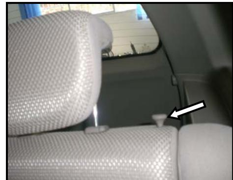
2. 拉起坐垫后下位置的座椅解锁手柄，使座椅解锁，并将座椅往前翻转到极限位置；
