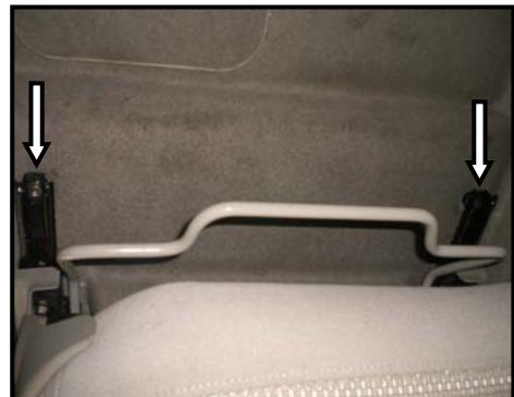
2. 拉起前后调节拉杆，把座椅推至最前位置，拆卸两固定螺栓。
